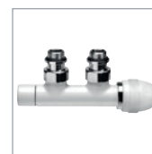
Ovus Set für Mittenanschluss (mit inneren Ventileinsatz und Handknopf) 1/2" x 24/19 - nur Zweirohr
